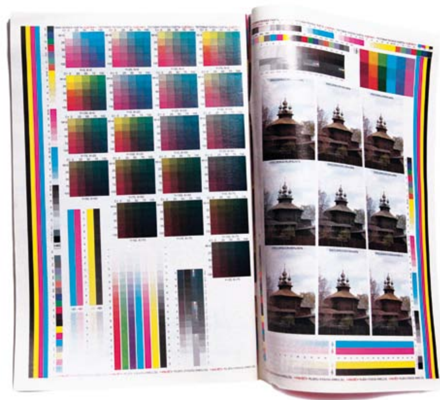
Тестовая техническая полоса для проверки качества печати и уточнения алгоритмов обработки изображений
